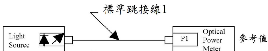
圖-1 鏈結損失測試方法-參考值 P1 測試
